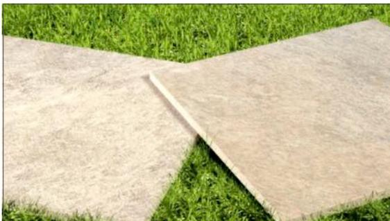
La cottura avviene ad una temperatura di circa 1150÷1250°C in forni lunghi sino a 140m dove la materia prima è portata gradualmente alla temperatura massima, lì mantenuta per circa 25÷30 minuti, e sempre gradualmente viene raffreddata sino a temperatura ambiente. Il processo di cottura determina la ceramizzazione/greificazione dell'impasto, attribuendone le tipiche caratteristiche di resistenza alle abrasioni, impermeabilità e longevità.
